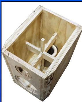
Suportes internos anti-vibração para aumentar a rigidez da estrutura
