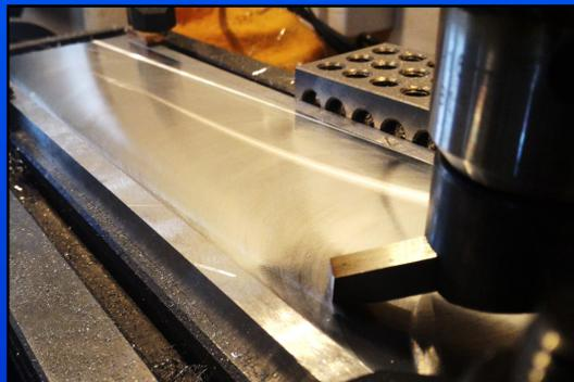
Usinagem em fresadora da placa frontal
